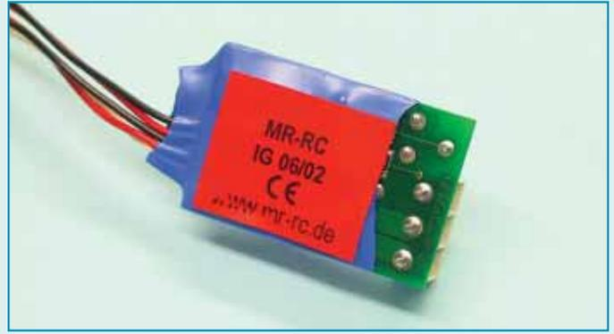
**Einziger Wermutstropfen: Auf der Rückseite des Gehäuses sind einige PINS nicht vom Schrumpfschlauch abgedeckt. Hier ist unbedingt vor Einbau ins Modell noch zusätzlich eine Isolierung anzubringen, um einen versehentlichen Kurzschluss zu vermeiden**
